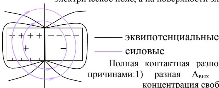
Полная контактная разность потенциалов, обусловленная обеими причинами: 1) разная  $A_{\text{вых}}$  электронов из металлов ( $U_{\text{вн}}$ ); разная концентрация свободных электронов ( $U_i$ ) равна:
